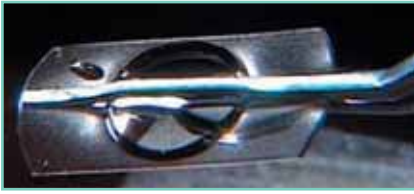
FIG. 5 : PRL : hydrophobie bien mise en évidence avec une gouttelette d'eau bien formée à sa surface.
